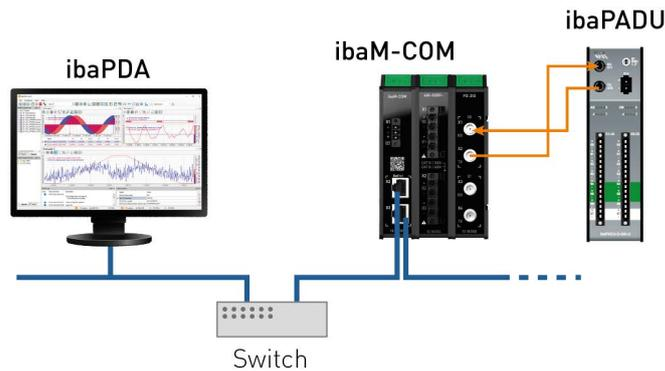
Wenn der *ibaPDA*-Rechner über eine Standard-Netzwerkkarte an das Netzwerk angeschlossen ist, ist eine synchrone Abtastung der Daten zwischen mehreren Teilnehmern von 1 ms möglich.
