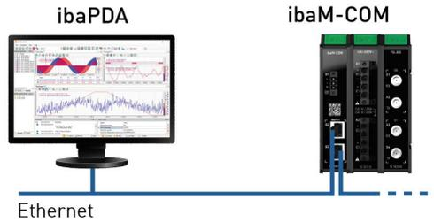
Die Netzwerktopologie ist dabei nicht von Bedeutung. Das Gerät kann wie in der Abbildung oben entweder direkt (P2P) mit dem *ibaPDA*-Rechner verbunden sein, oder über einen Switch bzw. Router, siehe nachfolgende Abbildung. Die an *ibaM-COM* angeschlossenen Module dienen lediglich als Beispiel.
