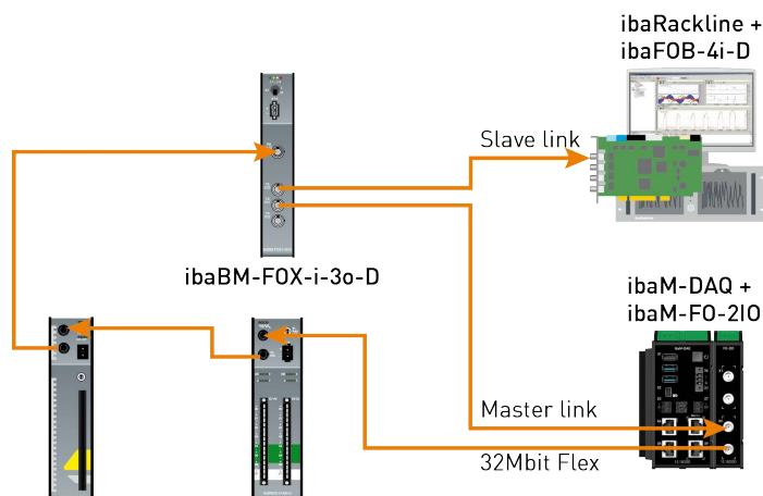
Für die Anschaltung im Beispiel oben mit *ibaBM-DIS-i-8o* gilt Gleiches wie mit *ibaBM-FOX-i-3o-D*. Das *ibaBM-DIS-i-8o*-Gerät muss dafür im Kopiermodus arbeiten ( $S1 = 0$ ).
