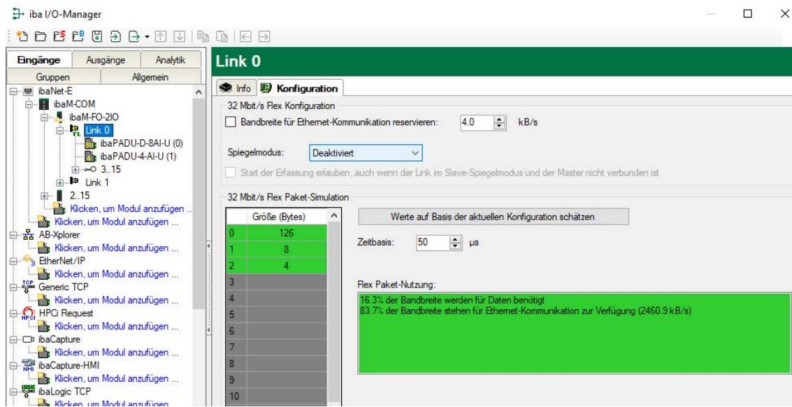
Zur Berechnung werden die Datenmenge (in Byte) jedes Geräts im Flex-Ring und die Zeitbasis (in  $\mu$ s) für die Datenerfassung im Ring benötigt.
