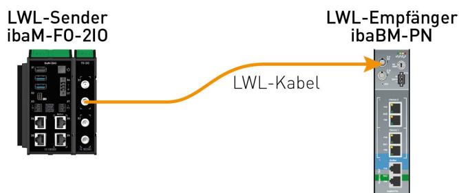
Das Beispiel bezieht sich auf eine Punkt-zu-Punkt-Verbindung mit einer LWL-Faser des Typs 62,5/125 µm. Die verwendete Lichtwellenlänge beträgt 850 nm.
