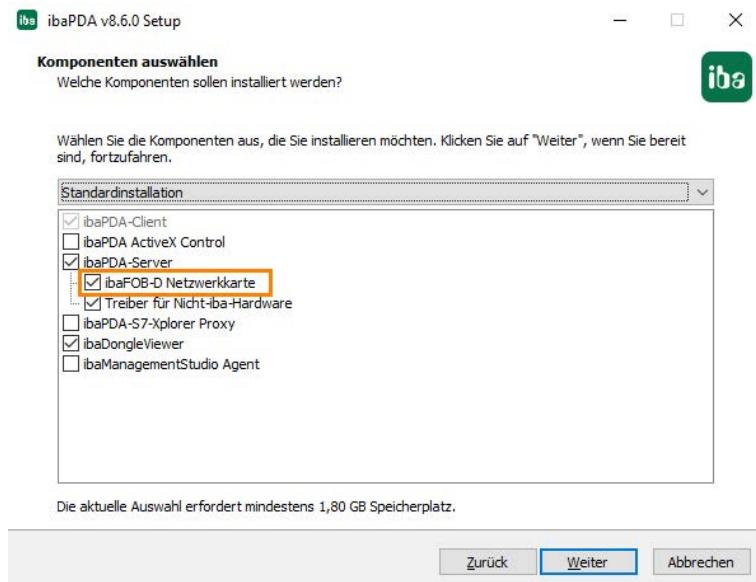
Optional kann die Installation des Treibers im Installationsassistenten auch abgewählt werden. Für eine individuelle Installation steht die Datei *ibaDevDrvInstaller.exe* zur Verfügung. Sie finden die Datei im Programmverzeichnis von *ibaPDA*, im Unterverzeichnis „Server“, z. B. *C:\Programme\iba\ibaPDA\Installers*.
