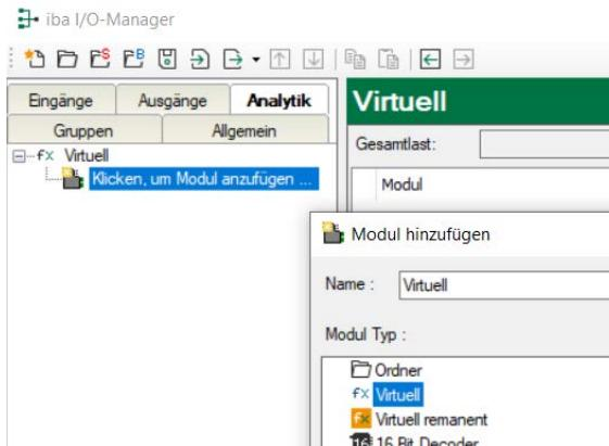
Mit dem Ausdruckseditor können spezielle virtuelle Funktionen für die Diagnose und zur Überwachung der LWL-Verbindungen ausgewählt werden. Diese stehen dann als sog. virtuelle Signale zur Verfügung und geben den aktuellen Status der Verbindung wieder. Diese Signale können in *ibaPDA* aufgezeichnet und weiter verarbeitet werden.
