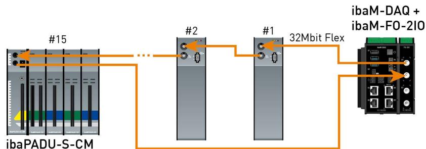
ibaPDA erkennt automatisch die Geräte im Flex-Ring und ermittelt die maximal mögliche Abtastrate, je nach Art und Anzahl der Geräte.
