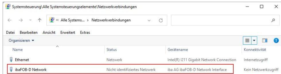
Diese Netzwerkverbindung wird im 32Mbit Flex-Modus benötigt, um über TCP/IP mit anderen Flex-Geräten zu kommunizieren, die ebenfalls über ein *ibaM-FO-2IO*-Modul angeschlossen sind. Diese Netzwerkverbindung gibt es nur einmal für alle installierten *ibaM-FO-2IO*-Module in einem ibaMAQ-System.
