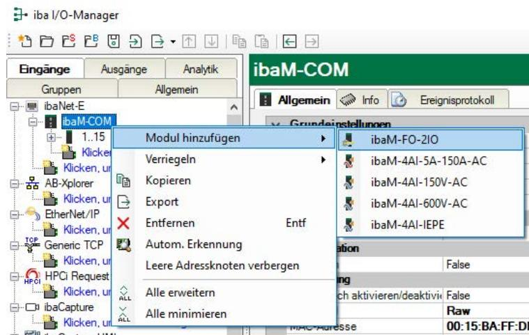
Mit einer Offline-Konfiguration ist es z. B. möglich, eine Modulkonfiguration ohne vorhandene bzw. angeschlossene Module zu exportieren oder die gesamte I/O-Konfiguration des I/O-Managers abzuspeichern.
