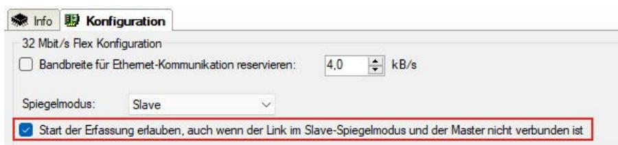
Wenn der *ibaPDA*-Master die Konfiguration ändert, während der *ibaPDA*-Slave Daten erfasst, startet der Slave die Erfassung automatisch neu.
