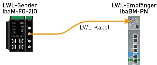
Das Beispiel bezieht sich auf eine Punkt-zu-Punkt-Verbindung mit einer LWL-Faser des Typs 62,5/125 µm. Die verwendete Lichtwellenlänge beträgt 850 nm.
