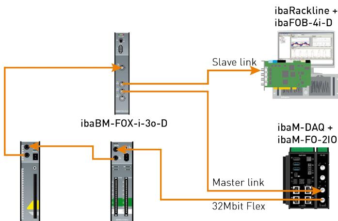
Für die Anschaltung im Beispiel oben mit *ibaBM-DIS-i-8o* gilt Gleiches wie mit *ibaBM-FOX-i-3o-D*. Das *ibaBM-DIS-i-8o*-Gerät muss dafür im Kopiermodus arbeiten ( $S1 = 0$ ).
