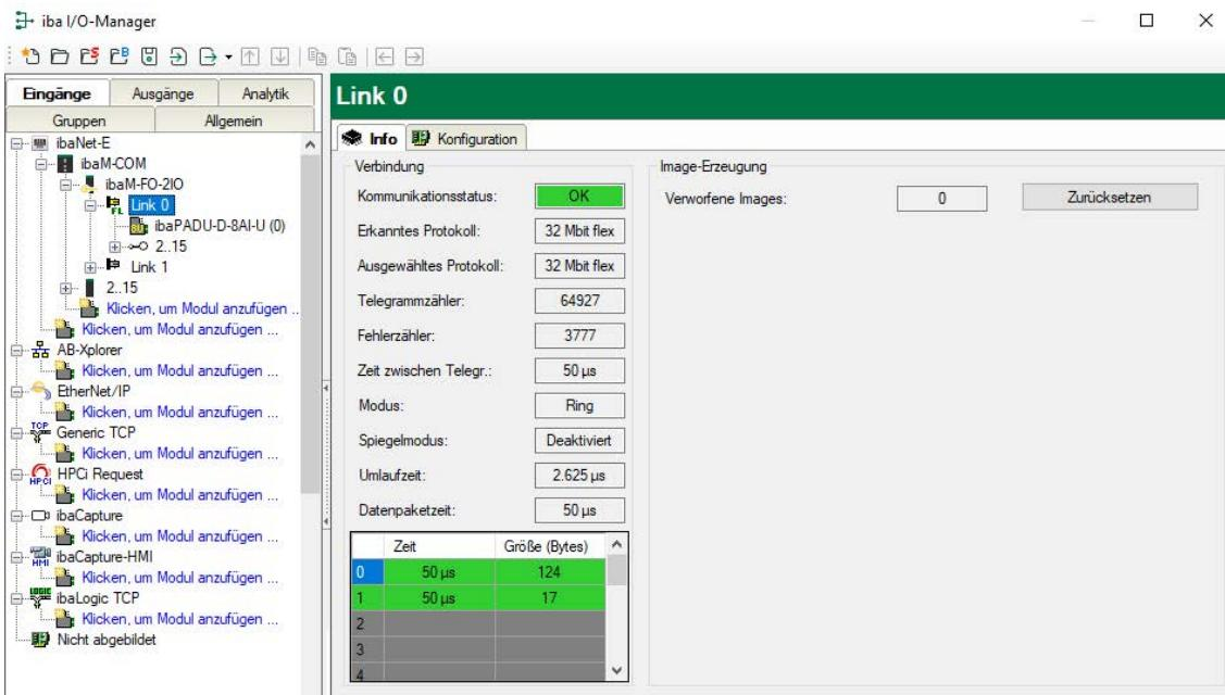
Pro Link können bis zu 15 Geräte in einer Ringstruktur angeschlossen werden. Im Signalbaum entsprechen die Positionen 1 - 15 unterhalb von *ibaM-FO-2IO* der Adresse, die mit dem Drehschalter am angeschlossenen Gerät eingestellt ist.
