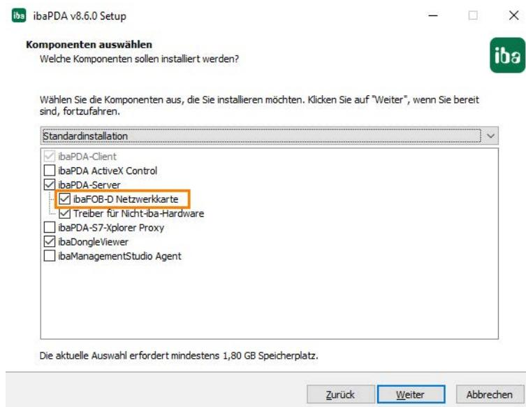
Optional kann die Installation des Treibers im Installationsassistenten auch abgewählt werden. Für eine individuelle Installation steht die Datei *ibaDevDrvInstaller.exe* zur Verfügung. Sie finden die Datei im Programmverzeichnis von *ibaPDA*, im Unterverzeichnis „Server“, z. B. *C:\Programme\iba\ibaPDA\Server*.
