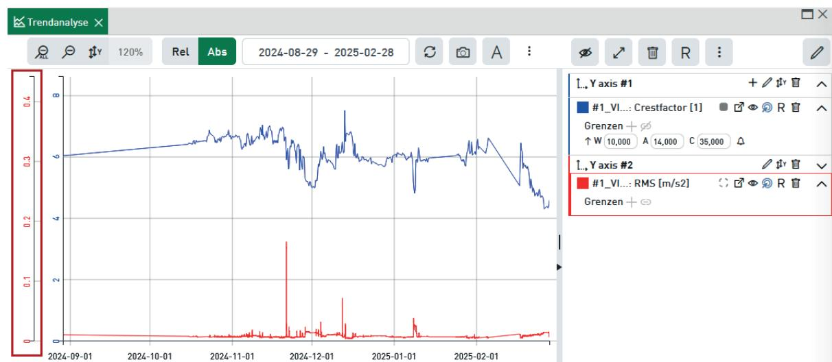
4. Passen Sie anschließend die Skalierung der neuen Y-Achse an, entweder mit dem Mausrad auf der Y-Skala oder indem Sie die Autoskalierung in der Trendlegende der Y-Achse ausführen.
