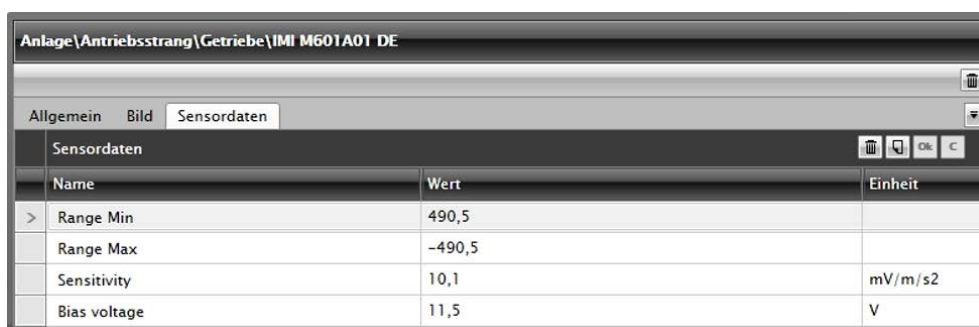
Abbildung 191: Sensordaten eines Schwingsensors
