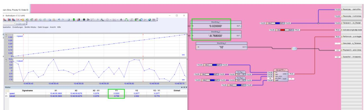
Hier sind es 10ms Werte bei einem Grundtakt von 1ms, die abgefragt werden. Pro Toggle wird in der Dat-Datei 10ms vorgegangen und der passende Wert gefunden und ausgegeben.
