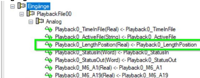
LengthPosition: aktuelle Längenpositon beim Abspielen längenbasierter Signale
