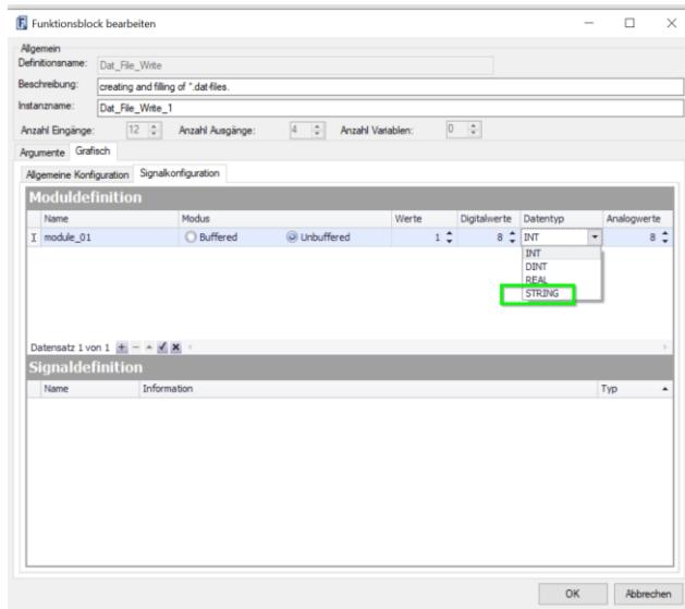
Achtung: Dies ist nur für ungepufferte Werte möglich. Bei gepufferten Signalen ist dies nicht erlaubt und man erhält eine entsprechende Meldung.
