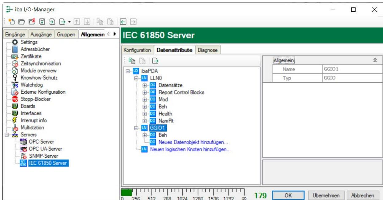
Bei Knotentypen mit optionalen Datenobjekten können diese manuell durch Klicken auf den Link *Neues Datenobjekt hinzufügen...* ergänzt werden. Der jeweils verfügbare Datenobjekttyp steht zur Auswahl.
