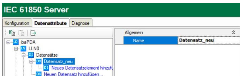
Dem neu erstellten Datensatz können Sie nun Datensatzelemente hinzufügen. Klicken Sie dazu auf den Link *Neues Datensatzelement hinzufügen....* Es öffnet sich ein Dialog, in dem alle verfügbaren Datenattribute aufgelistet werden.
