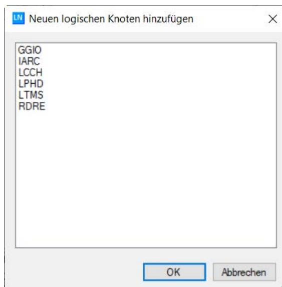
Wählen Sie einen Knoten aus und bestätigen mit <OK>. Der neue logische Knoten wird im Konfigurationsbaum hinzugefügt. Er enthält die obligatorischen Datenobjekte und die obligatorischen Attribute.
