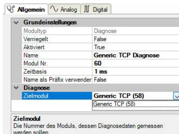
Die Grundeinstellungen eines Diagnosemoduls entsprechen denen der anderen Module. Sie müssen nur eine für das Diagnosemodul spezifische Einstellung vornehmen: das Zielmodul auswählen.
