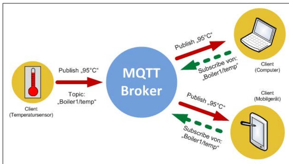
Für *ibaPDA* bedeutet dies, dass *ibaPDA* als MQTT-Client fungiert, der Daten an den MQTT-Broker senden und vom MQTT-Broker empfangen kann.
