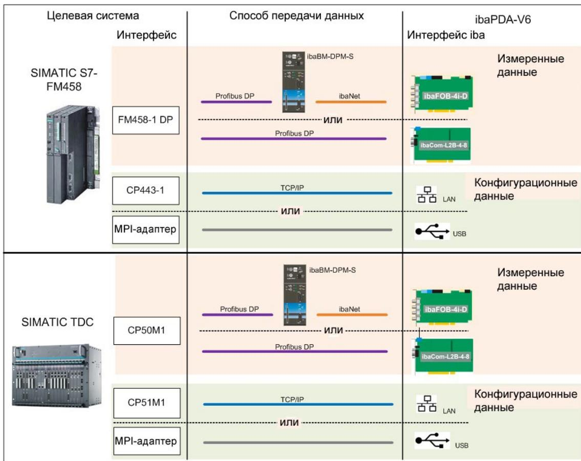
Для установления request-соединения и передачи каталогов адресов ibaPDA-V6 использует интерфейс программатора Siemens (PG-интерфейс). В зависимости от аппаратного и программного обеспечения, можно использовать различные точки доступа для сбора данных:
