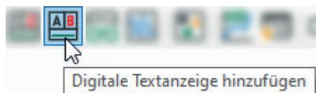
Grundlegender Unterschied ist, dass das Quellsignal für die Anzeige ein Textsignal ist. Der Text kann sowohl von außen empfangen als auch per Texteingabeelement in *ibaQPanel* eingegeben werden.
