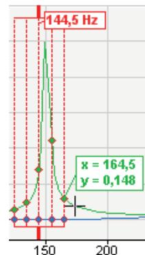
Harmonische und Seitenbandmarker können auch kombiniert angezeigt werden. Die Abbildung unten zeigt eine Ansicht mit einem harmonischen Marker unter und zwei über dem Hauptmarker. Der Offset des Seitenbands ist eingestellt auf 10 Hz.
