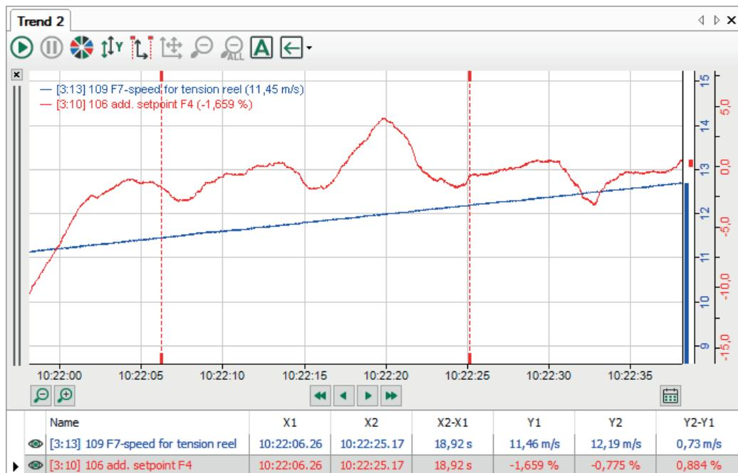
Im Pause-Modus sind die zwei Marker X1 und X2 im Graphen verfügbar. Sie können die Marker individuell einstellen, um die Y-Werte sowie die Unterschiede zwischen den X- und Y-Werten der Marker zu überprüfen.
