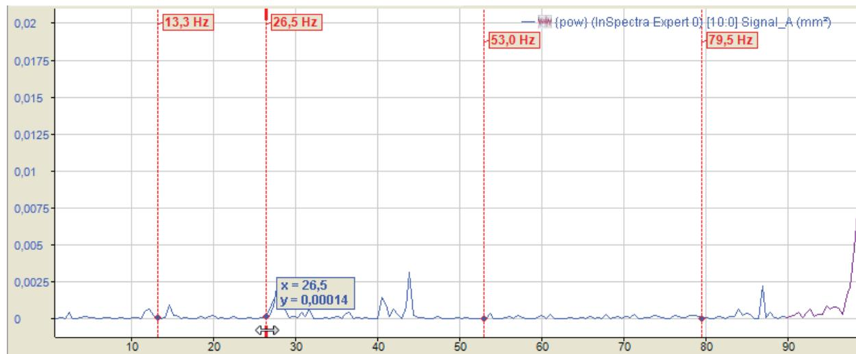
Die Abbildung oben zeigt einen interaktiven Marker mit 1 Harmonischen unter- und 2 Harmonischen oberhalb der Markerfrequenz von 26,5 Hz.
